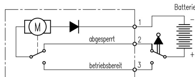
Nennspannung 24 VDC (+25/-30 %)
